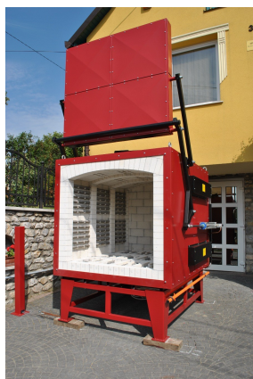
Egyedi 1,7 m 3 -es Hőkezelő kemence pneumatikus ajtónyitással
