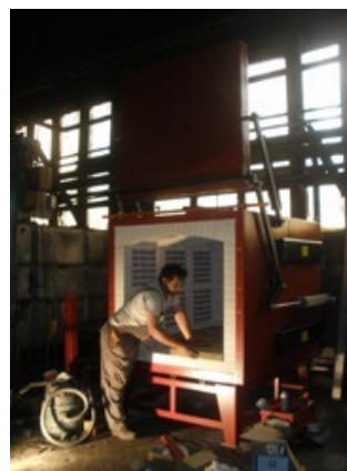
Egyedi 1,7 m 3 -es Hőkezelő kemence pneumatikus ajtónyitással
