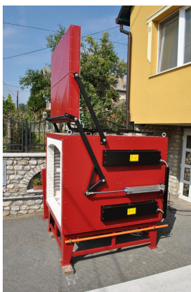
Egyedi 1,7 m 3 -es Hőkezelő kemence pneumatikus ajtónyitással
